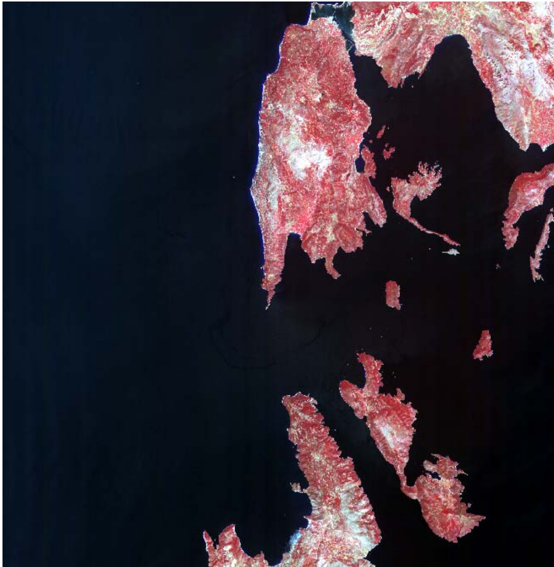
Σχήμα 10. Το έγχρωμο σύνθετο των καναλιών 1 ( μπλε ),2 (πράσινο), 3(κόκκινο) του SWIR στην οποία φαίνεται το φαινόμενο της ζωνοποίησης.
