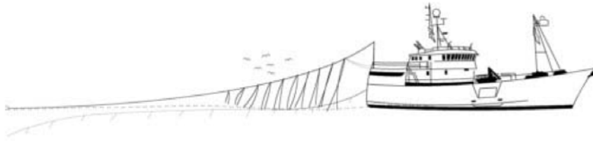
Εικόνα 6.20 Χρήση ειδικών ταινιών (tori line) που τρομάζουν τα πουλιά και τα αποθαρρύνουν στο να πλησιάσουν αλιευτικά εργαλεία π.χ. παραγάδι (πηγή: http://www.abcbirds.org ).
