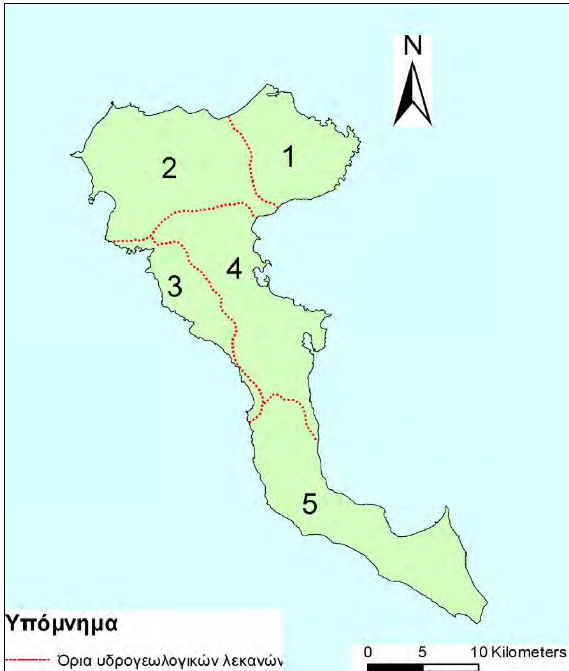
Εικόνα 4.2: Χάρτης της νήσου Κέρκυρας με τις 5 κύριες υδρογεωλογικές λεκάνες (από Υδρογεωλογική Μελέτη Νήσου Κέρκυρας, 1991, με τροποποιήσεις)
